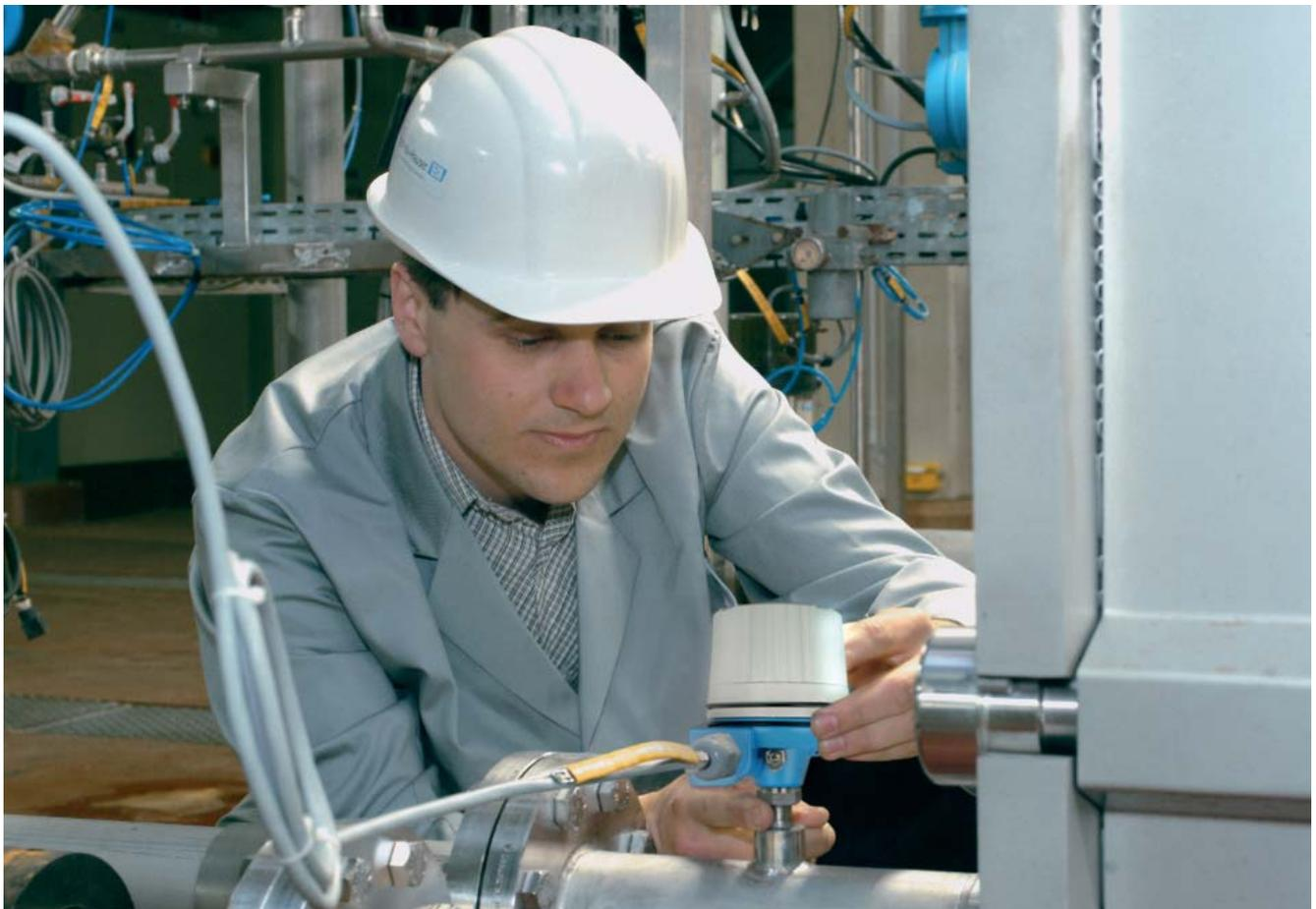
**Transmetteurs de température** Faites votre choix parmi les transmetteurs en tête de sonde, sur rail profilé ou en boîtier de terrain pour thermorésistance ou thermocouple et les gammes de mesure librement réglables. Qu'il s'agisse d'une sortie analogique, du protocole HART®, des interfaces FOUNDATION Fieldbus™ ou PROFIBUS PA, Endress+Hauser vous propose la bonne solution pour chaque point de mesure.
